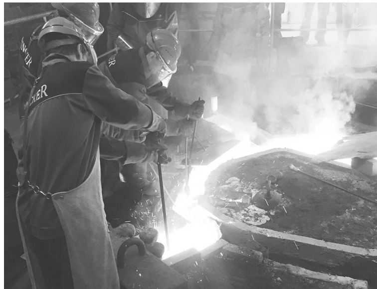
Het gieten van de klok op 4 september 2020 bij de firma Rincker in Sinn. Foto Hans Boekhoven.
